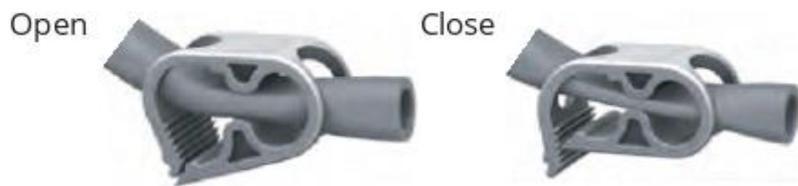
5. センターストラートのエアバルブが閉じていることを確認します。(5,6,7 m<sup>2</sup>のみ)
